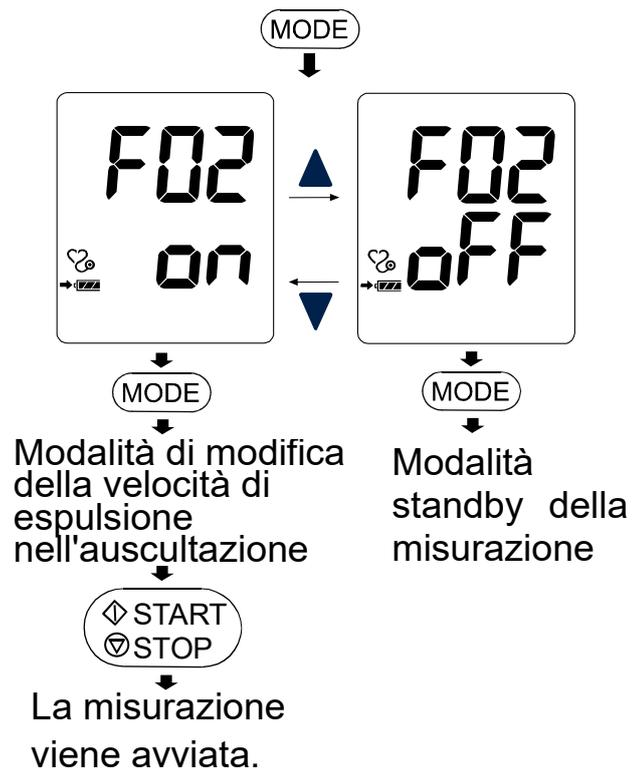
Premere il pulsante **AVVIO/ARRESTO** per iniziare la misurazione. Si noti inoltre che il dispositivo passa in modalità standby dopo un intervallo prestabilito.
