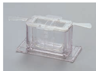
Kleiner Probenbecher (10ml) Verwendung zur Messung kleiner Probenmengen
